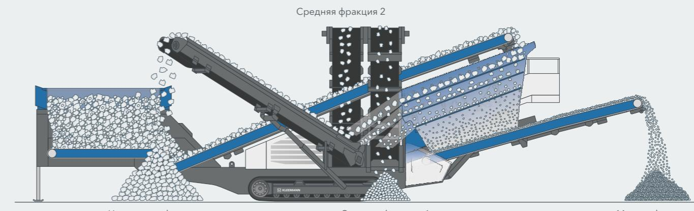
Поток материала на установках MSC 702(i) и MSC 703(i) EVO обеспечивает высокую производительность. Всё начинается с приёмного бункера, который отличается своей впечатляющей вместимостью и расширяется по направлению потока материала. Таким образом, материал передаётся через разгрузочный конвейер бункера с оптимальным распределением на загрузочный конвейер увеличенной ширины. Благодаря отбойным пластинам на разгрузочном конце конвейера и на участке
