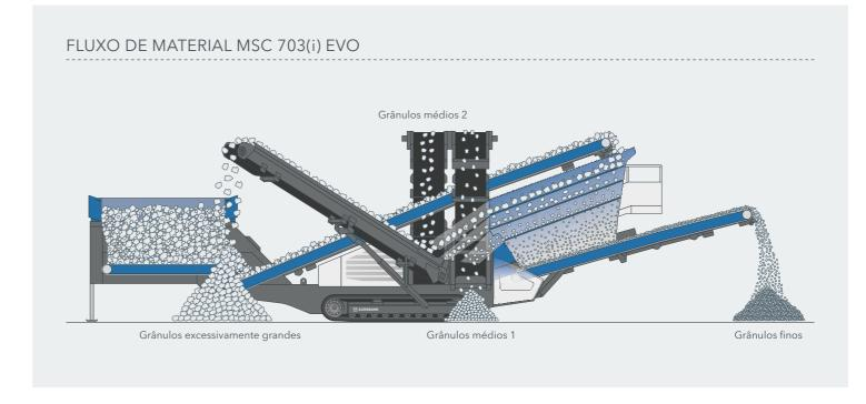
O fluxo de material da MSC 702(i) e MSC 703(i) EVO está preparado para um alto desempenho. Começando na tremonha de alimentação, que dispõe de uma impressionante capacidade e que se alarga na direção do fluxo do material. O material é assim enviado através da correia de descarga da tremonha, perfeitamente distribuído, para a correia de alimentação extralarga. As placas de impacto na descarga da correia e a alimentação da caixa da peneira permitem distribuir o material de modo uniforme sobre
