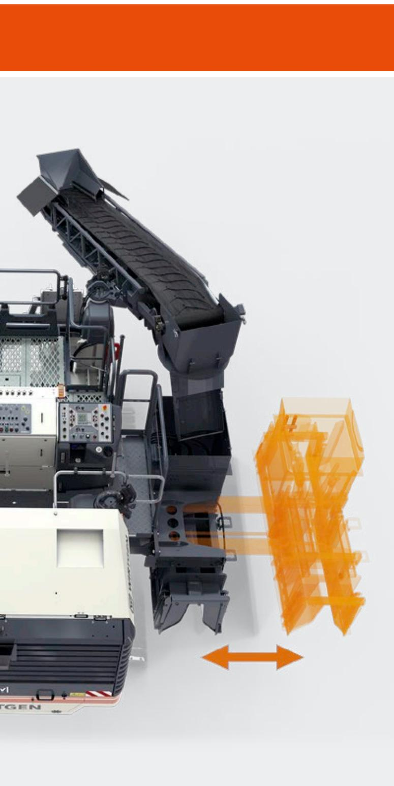
**01** O sistema de alimentação - opcional usando esteira transportadora ou rosca alimentadora - pode ser girado hidráulicamente para a direita ou para a esquerda. O molde deslizante pode ser montado à direita ou à esquerda e estendido hidráulicamente na lateral.
