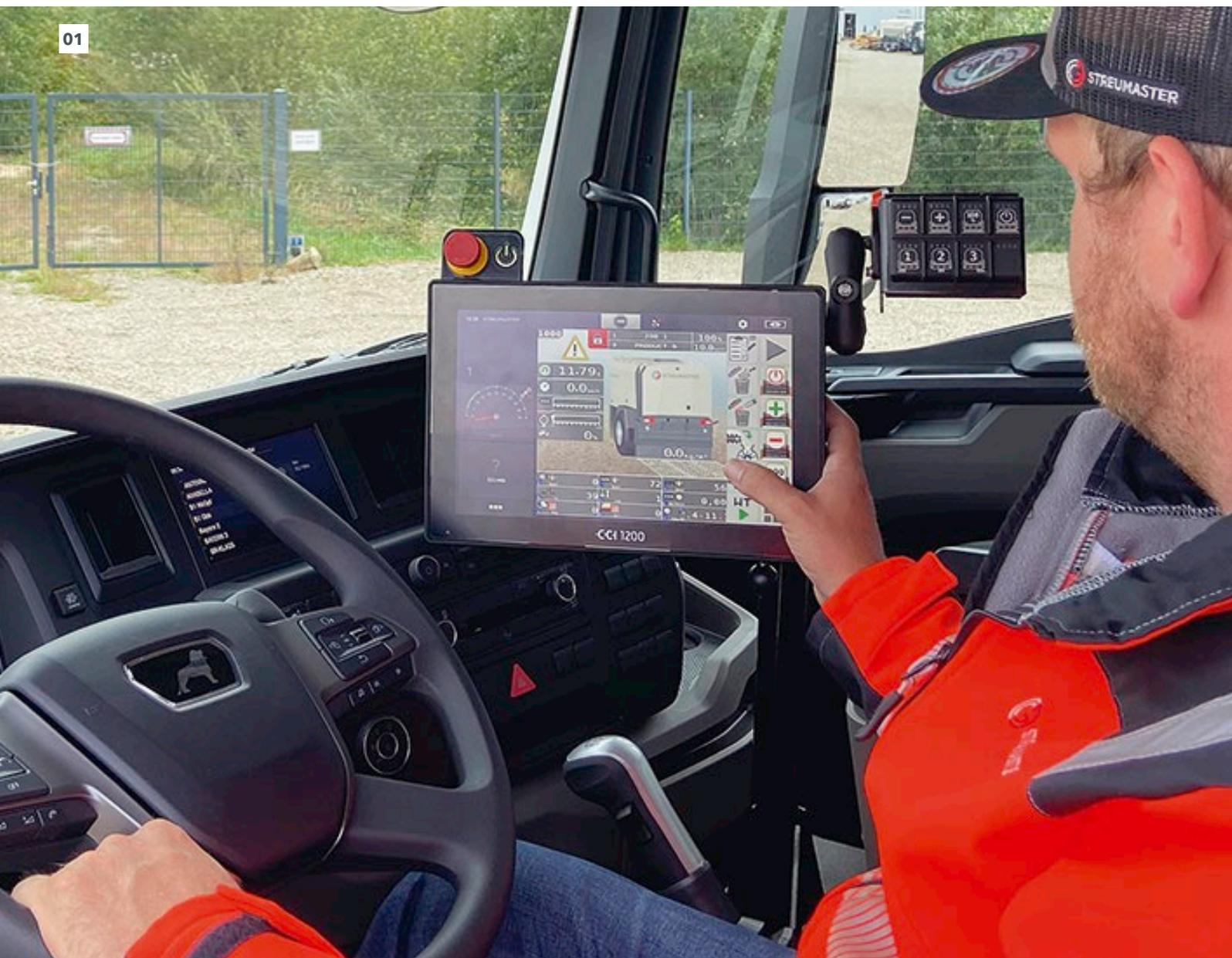
si el depósito está «casi lleno» o «lleno». Esto permite supervisar de forma sencilla el nivel de llenado. En combinación con WeighTronic hay disponible de forma opcional una indicación del peso en la parte trasera del depósito. Durante el proceso de llenado, así se puede leer y controlar en todo momento desde el exterior el peso de llenado que hay en el depósito.
