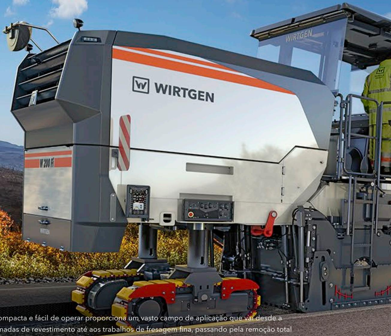
A fresadora a frio compacta e fácil de operar proporciona um vasto campo de aplicação que vai desde a recuperação de camadas de revestimento até aos trabalhos de fresagem fina, passando pela remoção total do pavimento.
