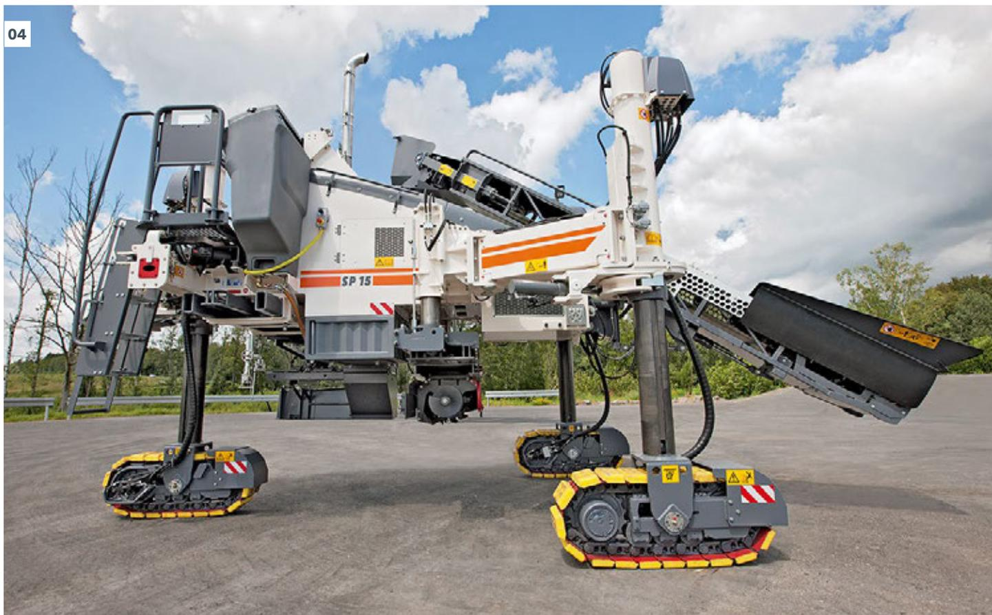
**03** O sistema de troca rápida possibilita a troca rápida do molde deslizante no canteiro de obras.
