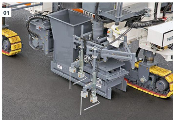
01 - 02 O molde deslizante pode ser hidráulicamente estendido em até 700 mm para fora.
