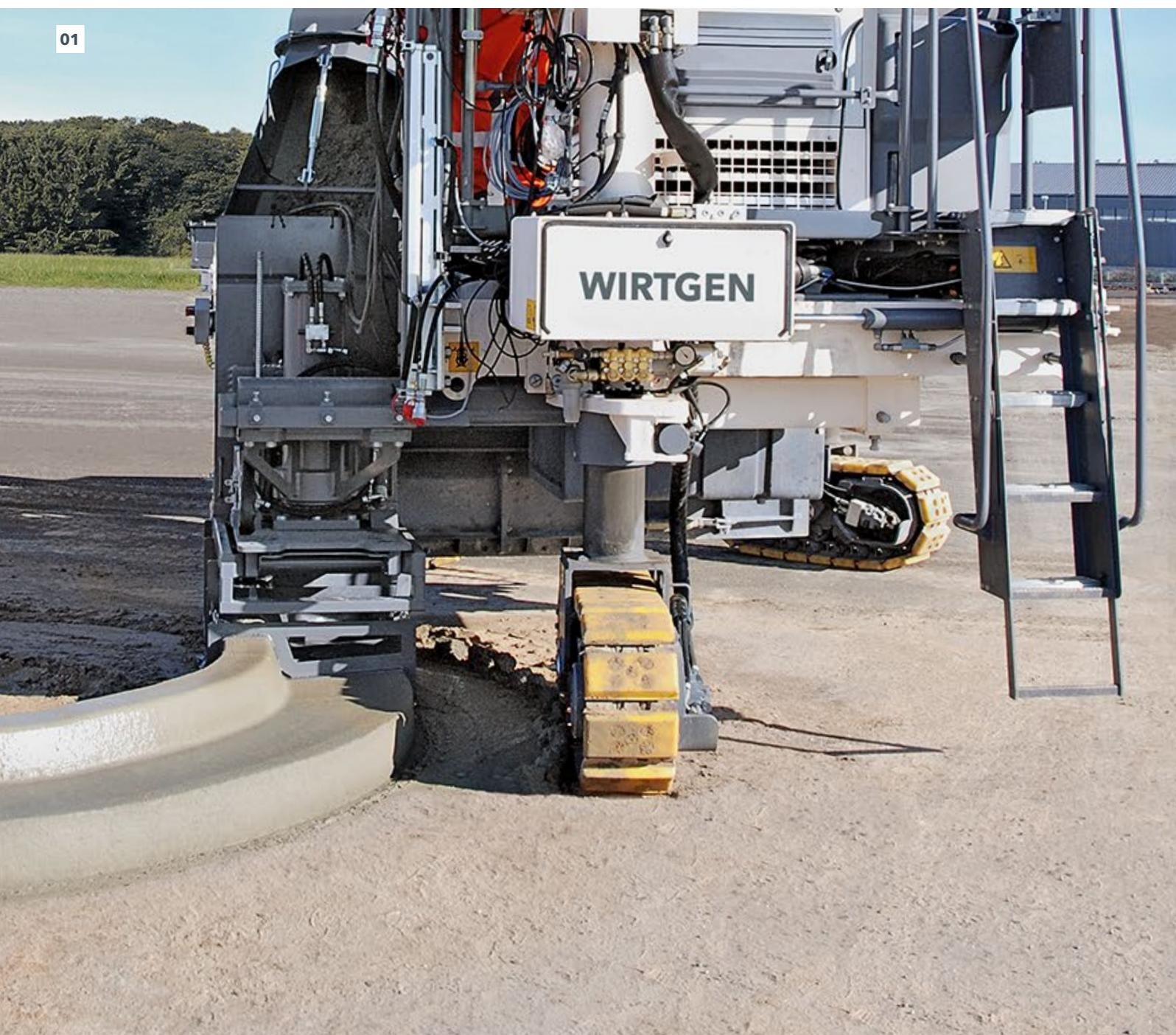
**01** A SP 15(i) permite um raio de instalação de 500 mm - ou ainda menor - sem o uso de fio-guia.
