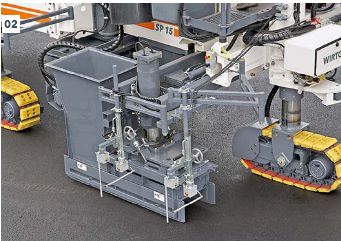
01 - 02 Die Gleitschalung lässt sich hydraulisch um bis zu 700 mm nach außen teleskopieren.
