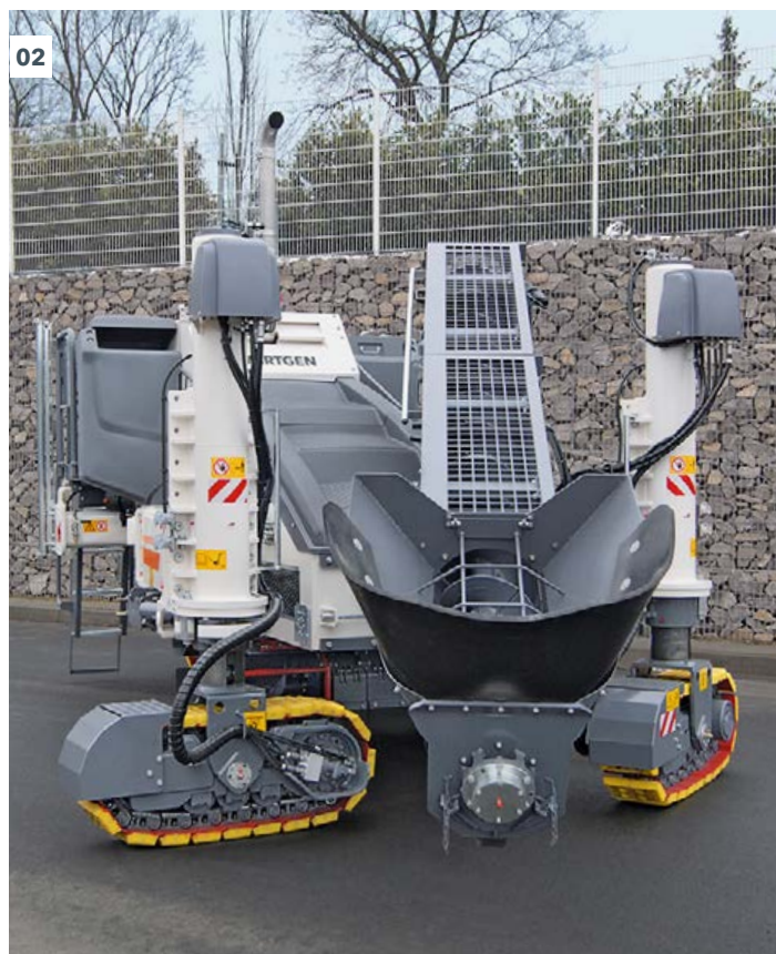
01 - 02 Der SP 15(i) wird wahlweise mit Förderband oder Förderschnecke ausgestattet.
