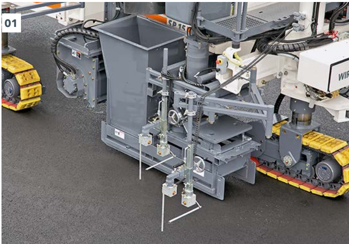
01 - 02 Die Gleitschalung lässt sich hydraulisch um bis zu 700 mm nach außen teleskopieren.
