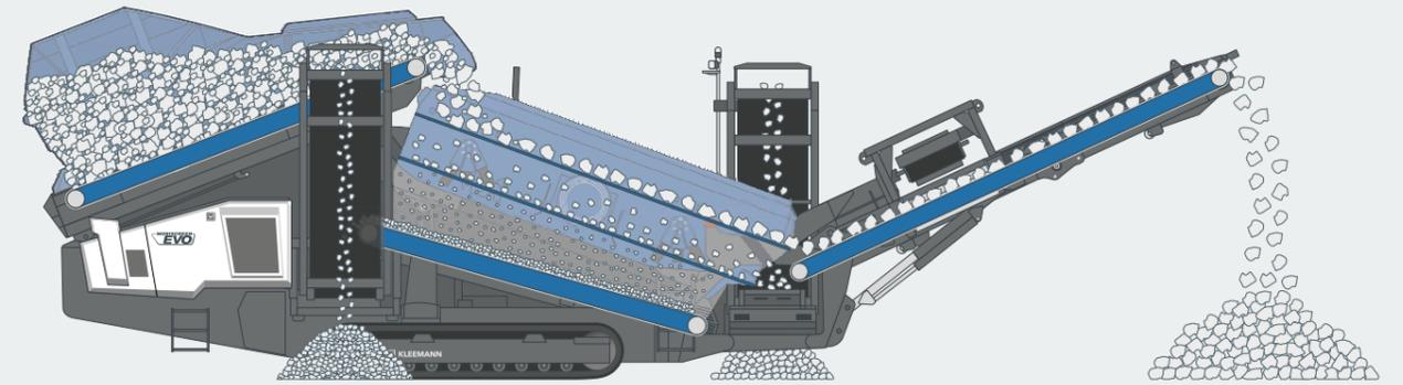
Avec son châssis à commande proportionnelle, le crible pour produits surclassés peut être déplacé rapidement et précisément, que ce soit de la remorque surbaissée au lieu d'utilisation ou au sein du chantier. Le basculement des convoyeurs de déchargement latéraux s'effectue sans montage/démontage de composants et permet ainsi de réduire les temps d'équipement. Un volet de
