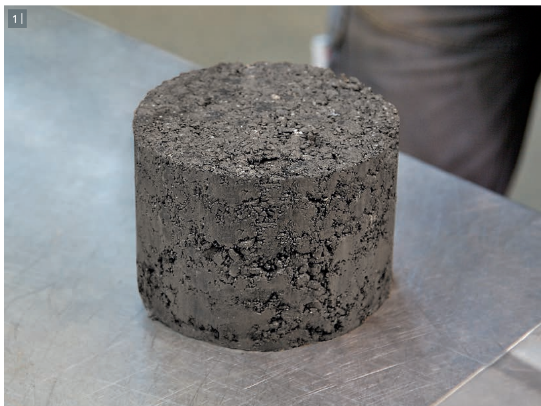
1 | O material tratado com espuma de asfalto se destaca pela excelente rigidez e capacidade de carga.
