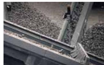
Gli impianti mobili di vagliatura MOBISCREEN MS 952 e 953 EVO vengono utilizzati come vagli separatori. Essi dispongono di un grande cassone del vaglio da 9,5 m<sup>2</sup> e soddisfano così requisiti elevati di performance.
