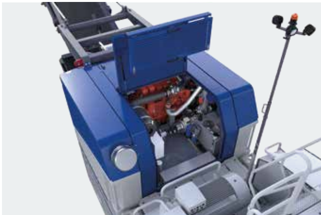
> MC 120 Z PRO - Accesibilidad óptima al compartimento del motor
