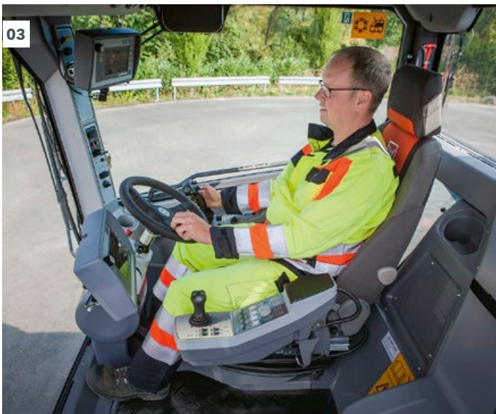
03 - 04 El asiento confortable con posibilidad de ajuste individualizado coloca al maquinista en la posición ideal.
