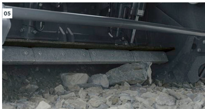
03 Las barras quebrantadoras dotadas de metal duro de los niveles de trituración fijo y variable les sirven a las herramientas de trituración HT18 a modo de contracuchilla y permiten así triturar la roca.
