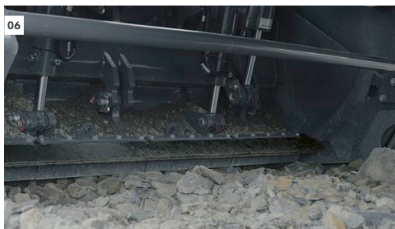
04 La roca gruesa se acumula delante de la aleta de alimentación. 05 La aleta de alimentación se abre manualmente y la roca se desplaza al interior de la carcasa de trituración y mezcla al pasar sobre ella. 06 La aleta de alimentación se cierra para minimizar la expulsión hacia delante.
