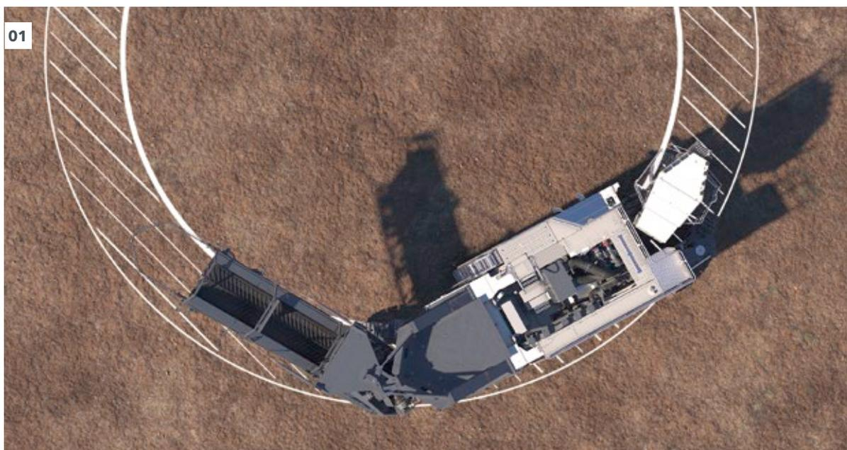
d'un bouton. Pour le positionnement, la direction est assurée par les trains de roulement arrière et avant en sens opposé ; pour les longs tronçons en ligne droite, seuls les trains de roulement avant sont utilisés. En « marche en crabe » - pour le déplacement latéral de la machine - les quatre trains de roulement avancent dans le même sens.
