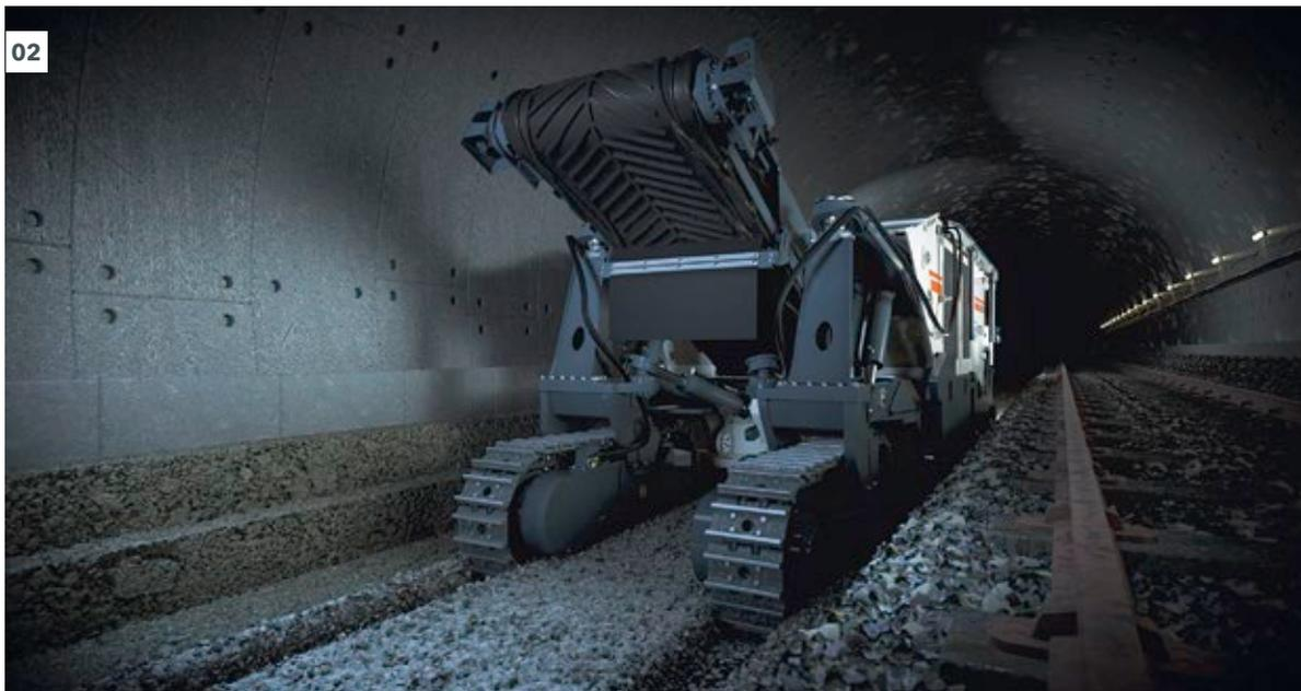
**02** Le 260 SX(i) dépose les gravales extraites en continu selon le procédé Cut-to-Ground.
