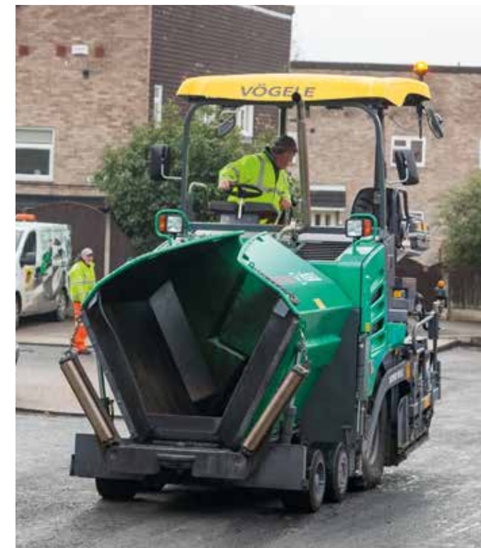
При подъеме стенок бункера упорные ролики для самосвала тоже автоматически поднимаются вверх.
