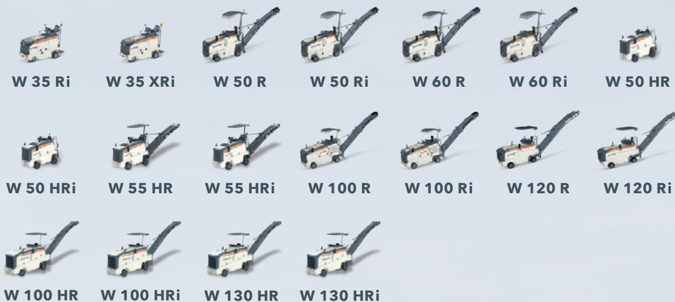
**FRAISEUSES COMPACTES** > Largeur de fraisage allant jusqu'à 1 900 mm > Profondeur de fraisage allant jusqu'à 330 mm
