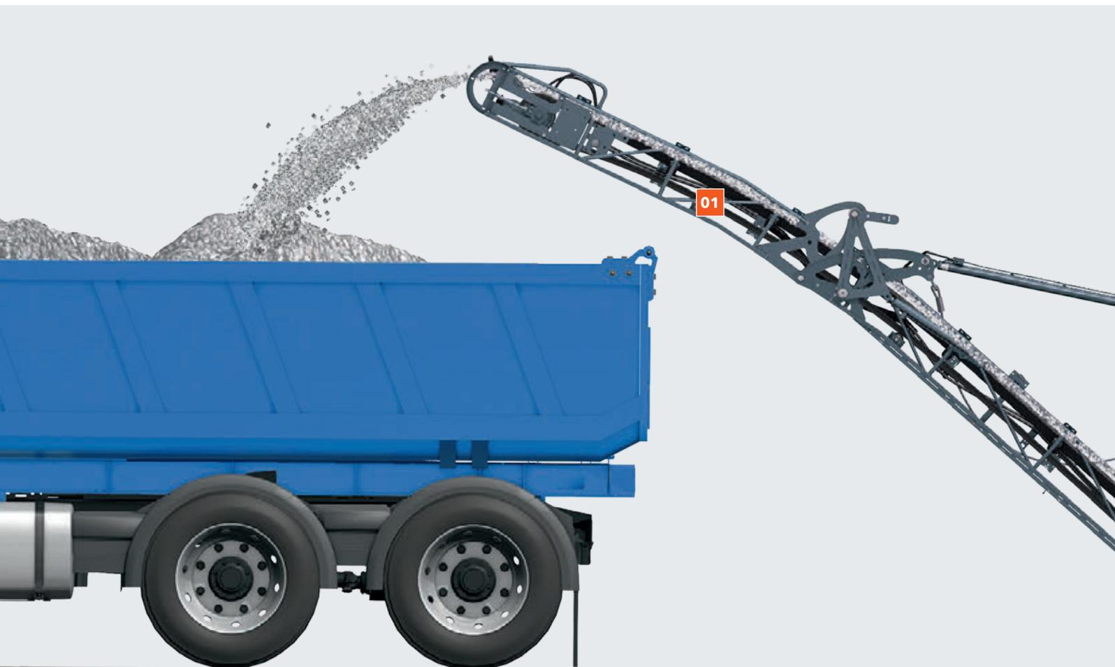
**01** Bande de chargement pivotable et réglable en hauteur
