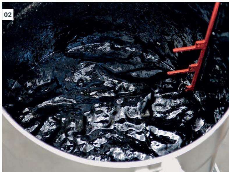
**01 - 02** Le processus de montée en mousse s'effectue dans des chambres d'expansion où l'air et l'eau sont injectés à une pression d'environ 5 bars dans le bitume chauffé à une température comprise entre 160 à 180 °C.
