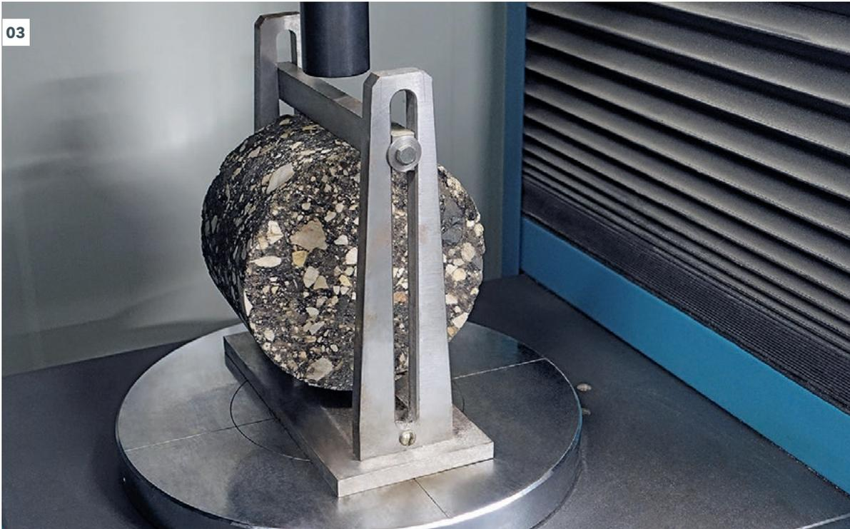
**03** Contrôle de la qualité par essai de compression diamétrale.
