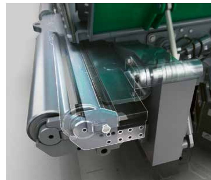
Il rullo respingente a molle "PaveDock" compensa in modo affidabile gli scossoni trasmessi dagli autocarri di rifornimento materiale.
