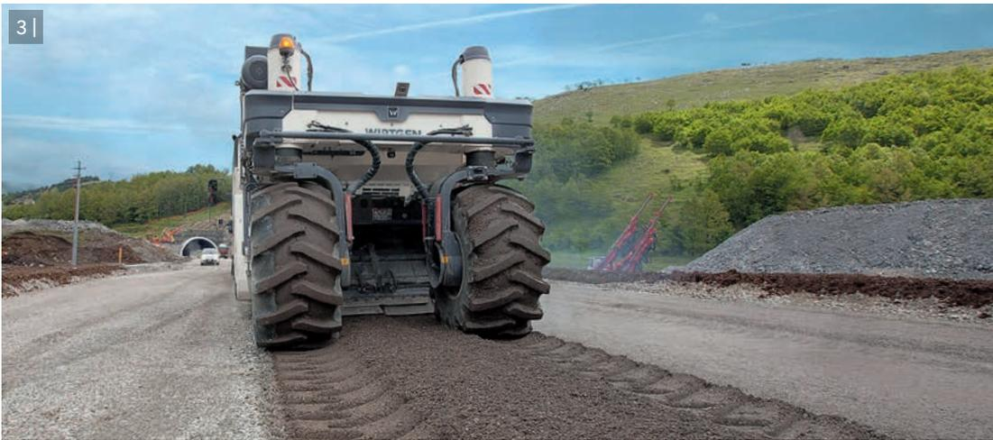
2-3 | Aglomerado de asfalto, tratado de forma homogénea, detrás de la recicladora en frío.
