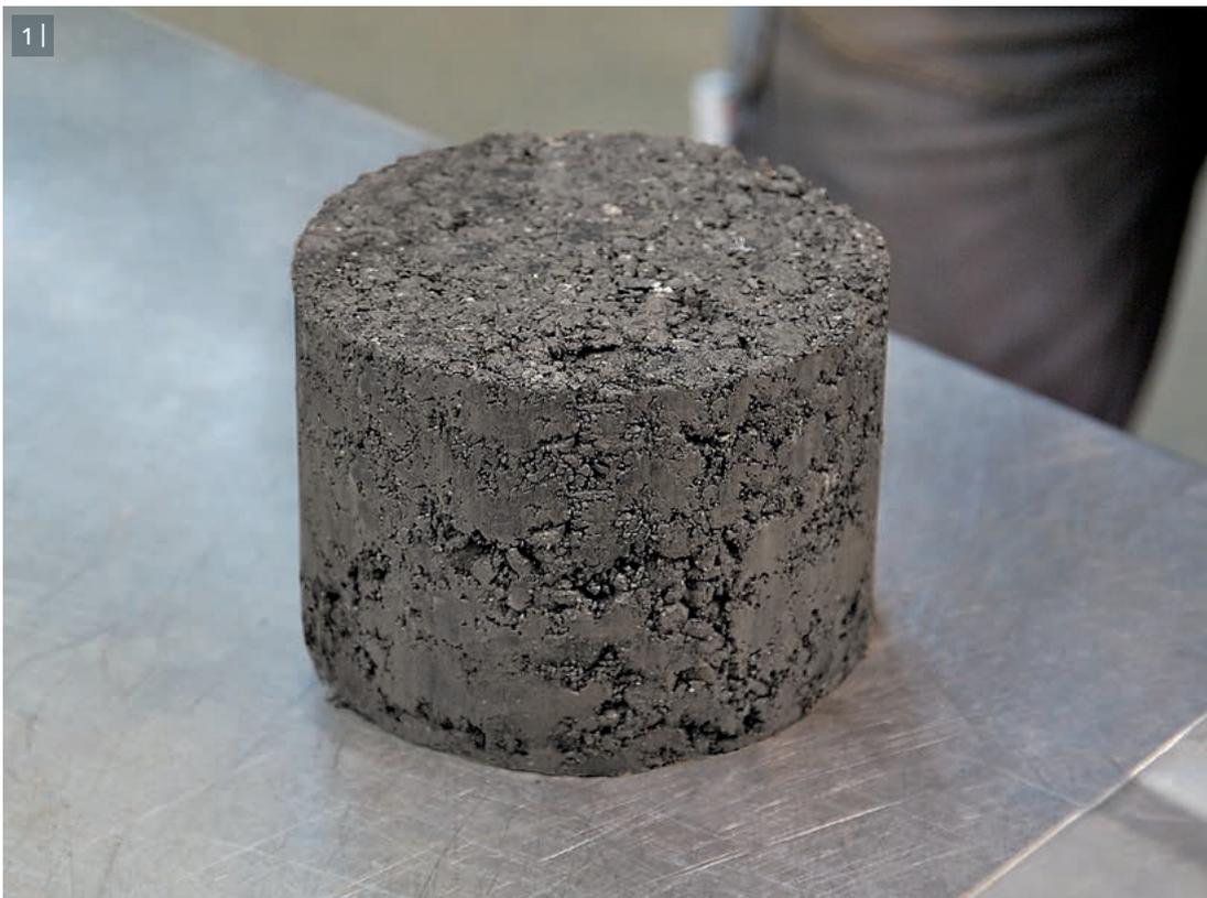
**1 |** El material tratado con betún espumado destaca por su solidez y su capacidad de carga óptimas.
