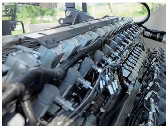
2 | *... la adición exacta en toda la anchura de trabajo en función del avance de la máquina y la profundidad de reciclaje.*
